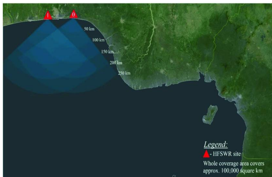
شکل ۱: نمونه ای از یک رادار دریایی موج سطحی (Nikolic et al,2018)
